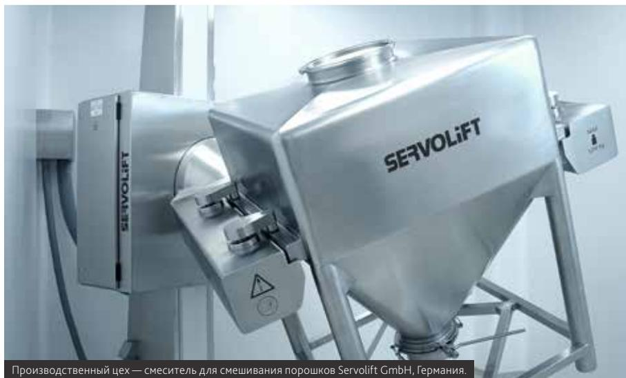
Производственный цех — смеситель для смешивания порошков Servolift GmbH, Германия.
